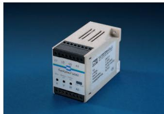
Bei dem Sanftanlaufgerät Typ SSAZ handelt es sich um ein **Sanftanlauf- und Sanftauslaufgerät** mit einer Leistung von 1,5kW - 3 KW. Hier ist in zwei der drei Phasen ein Leistungshalbleiter integriert .
