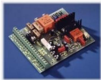
Der Motorregler für DC-Motoren MTR 201 ist ein Motorregler in Platinenausführung und kann in Schaltschränke oder andere Gehäuse eingebaut werden.
