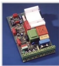
Kompaktheit zeichnet diese Baureihe aus. Bei dieser Baureihe ist sowohl Ankerspannungsregelung ( $I \times R$ ) als auch Tachorückführung möglich.
